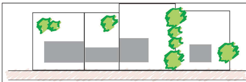
Implantation autorisée en cas de présence de végétations d'intérêt sur la limite séparative
